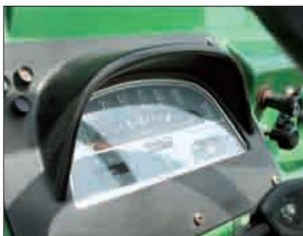
Si le tachymètre est bien celui de la 2 CV6, le support et sa visière ont été réalisés par Fiberfab.
