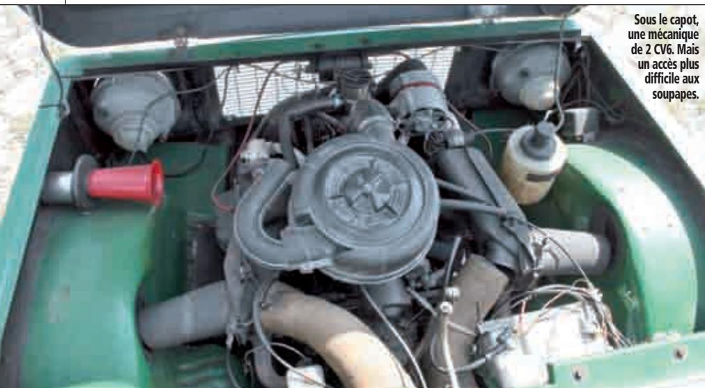
Sous le capot, une mécanique de 2 CV6. Mais un accès plus difficile aux soupapes.
