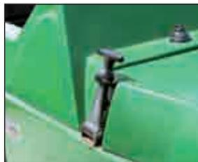
Pour maintenir le capot fermé, de simples attaches rapides en caoutchouc.
